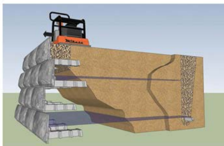
Figura 36 - Faceamento Lock & Load ®
